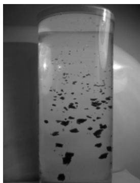
Рис. 3. Седиментаційний аналіз осадження подрібнених частинок тестового матеріалу
