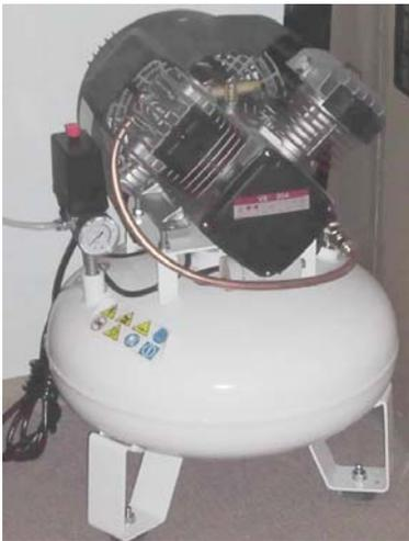
Рис. 8. Безмасляный компрессор в составе гипоксикатора с газоразделением
